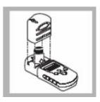
3、擦干净空白样品池 外壁,将其插入样品池 固定架,菱形标记面向 显示屏。盖上遮光盖。
