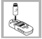
9、对于总氯,擦干净样品池外壁,插入样品 池固定架,菱形标记面 向显示屏。盖上遮光 盖,等待3到6分钟。 执行步骤10。
