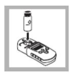
8、对于余氯,迅速 擦干净样品池外壁, 插入样品池固定架, 菱形标记面向显示 屏。盖上遮光盖,立 即执行步骤 10。在 1 分钟内完成步骤 7 和 8。
