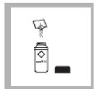
6、制备样品: 加一包 DPD 余氯试剂粉包 (21055-69)或 DPD 总氯 试剂 粉 包 (21056-69)到样品池 中。
